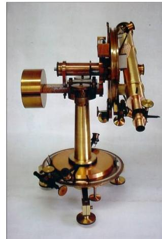
Figura 2 (a e b) - Teodolito, fabricado por Brunner Frères, (a) antes e (b) após a restauração (acervo MAST).
